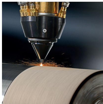
Beschichten einer Walze mit High-Power EHLA © Fraunhofer ILT
